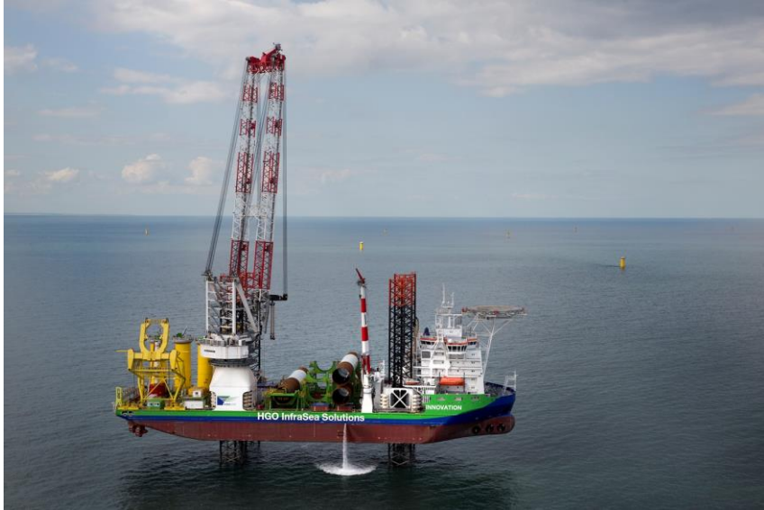
Het jack-up vaartuig 'Innovation' van GeoSea, terwijl het installatiewerken op het 'Westermost Rough' offshore windmolenpark uitvoert, VK
