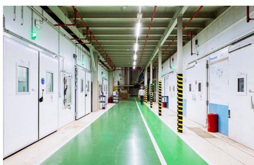
VMA dotera les salles d'essai de technologies permettant d'exposer les pompes à chaleur et les systèmes de refroidissement à des conditions météorologiques extrêmes. Les tests seront automatiquement pilotés grâce au logiciel VMANAGER de VMA, habituellement utilisé pour la gestion intelligente de grands bâtiments, mais qui trouve ici sa première application industrielle.
