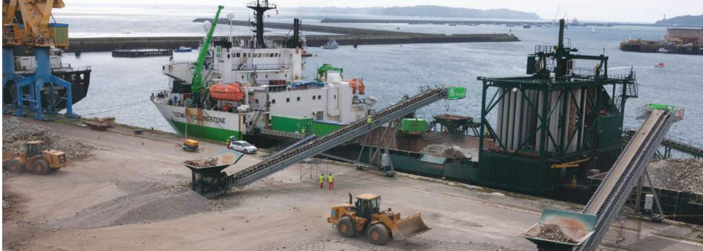
Le navire DP 'Rollingstone' effectue des enrochements pour la protection et la stabilisation d'oléoducs, de gazoducs et de câbles
