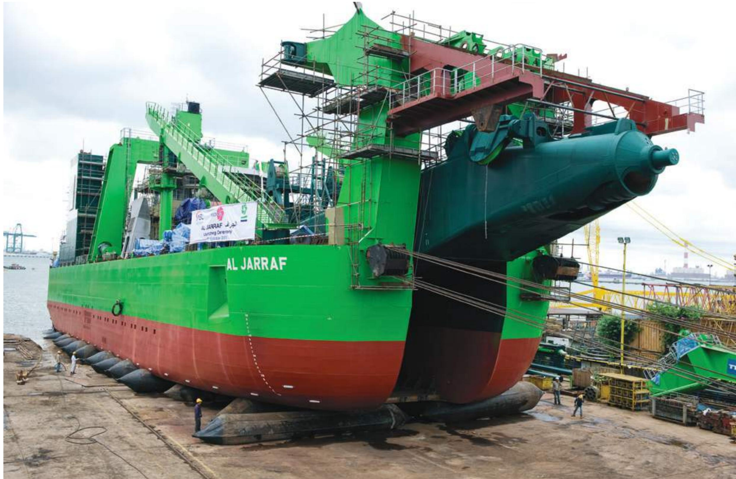
Mise à l'eau de la drague à désagrégateur autopropulsée 'Al Jarraf' - Singapour (SGP)
